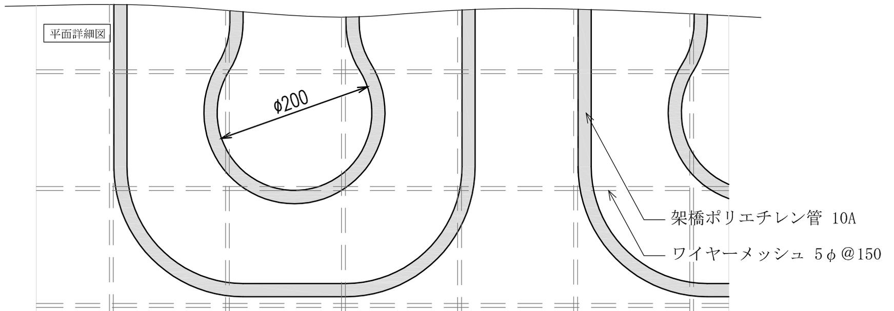
耐圧基準 : 配管、ヘッダー、継手をセットした状態で耐圧0.5Mpa以下
